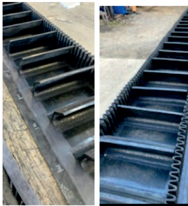
Rys. 12. Taśma przenośnikowa z falbanami 300 mm i poprzeczką TC-280 podczas montażu Fig. 12. Conveyor belt with sidewalls H-300 and TC-280 cleat profiles during assembly
