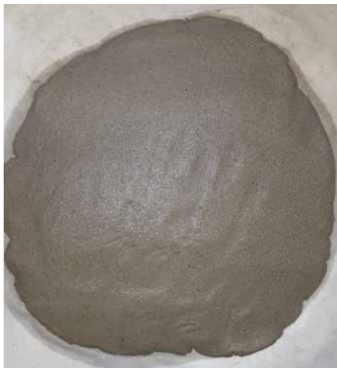
Fot. 1. Masa uzyskana po zwilżeniu mieszanki gnejsu i dolomitu wodą wodociągową
