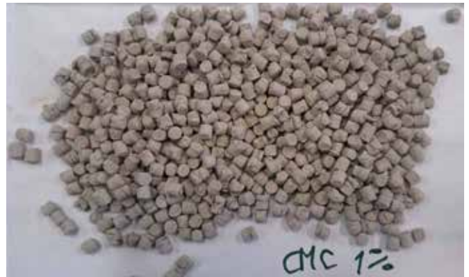
Fot. 6. Granule uzyskane przy granulacji z 1% dodatkiem CMC Photo 6. Granules obtained during granulation with 1% of CMC
