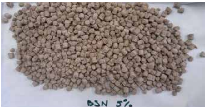
Fot. 4. Granule uzyskane przy granulacji z 5% dodatkiem BSN Photo 4. Granules obtained during granulation with 5% BSN
