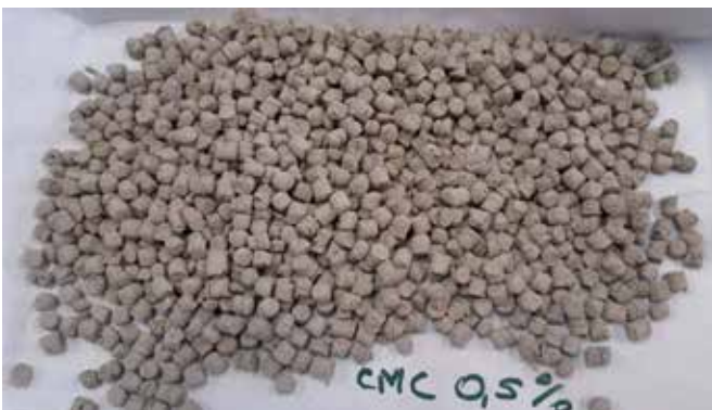
Fot. 5. Granule uzyskane przy granulacji z 0,5% dodatkiem CMC Photo 5. Granules obtained during granulation with 0,5% of CMC
