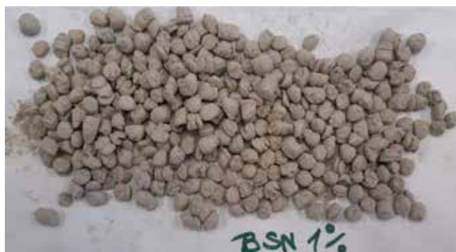
Fot. 2. Granule uzyskane przy granulacji z dodatkiem 1% BSN
