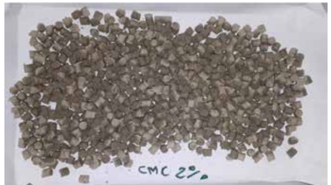
Fot. 7. Granule uzyskane przy granulacji z 2% dodatkiem CMC Photo 7. Granules obtained during granulation with 2% of CMC
