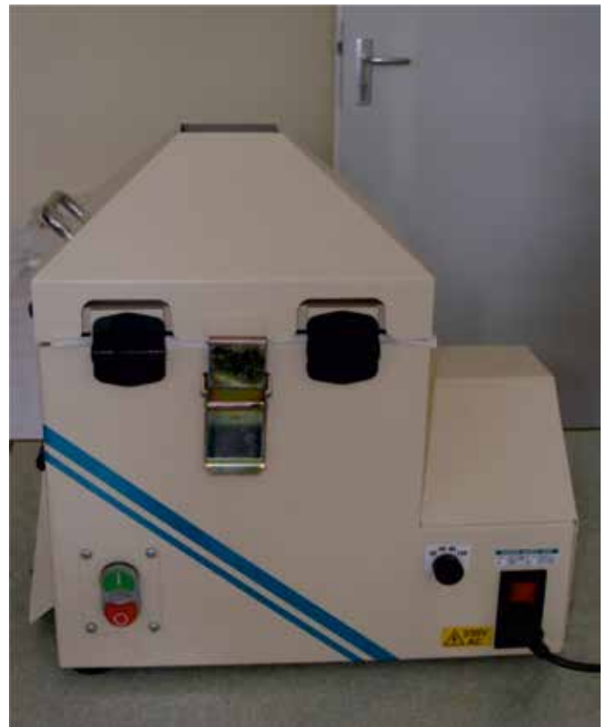
Fot. 8. Tester do badania jakości granulatu NEW HOLMEN PORTABLE NHP100
