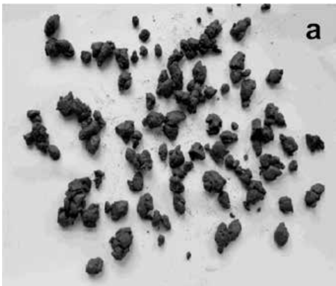
Rys. 1. a) masa uzyskana po zwilżeniu mieszanki bazaltu i siarki wodą wodociągową; b) wygląd granulek Fig. 1. a) the mass obtained after wetting a mixture of basalt and sulfur with tap water; b) the appearance of the granules
