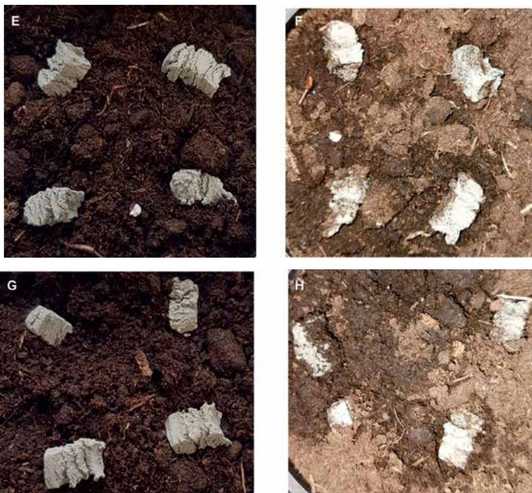
Rys. 7. Testy wazonowe granulatów: A) granulaty kontrolny (woda), B) granulaty kontrolny (woda) po 48h, C) granulaty z 5% dodatkiem bentolizera SN (proszek), D) granulaty z 5% dodatkiem bentolizera SN (proszek) po 48h, E) granulaty z 2% dodatkiem CMC (proszek), F) granulaty z 2% dodatkiem CMC (proszek) po 48h, G) granulaty z 5% dodatkiem bentolizera SN i 2% dodatkiem CMC (proszki) po 48h, H) granulaty z 5% dodatkiem bentolizera SN i 2% dodatkiem CMC (proszki) po 48h
