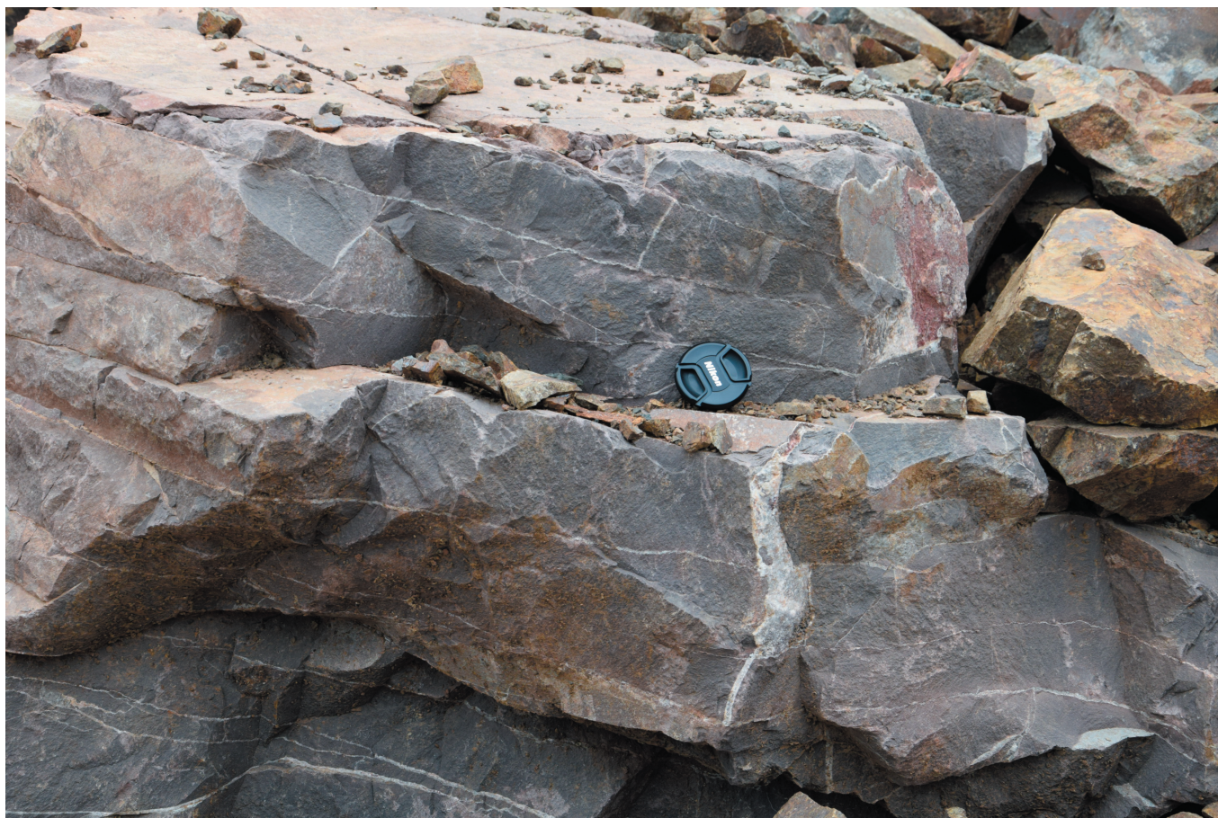
Rys. 3. Fragment bloku melafirowego z licznymi żyłkami wypełnionymi kalcjtem Fig. 3. A block of the melaphyre (fragment) with many veinlets filled with calcite
