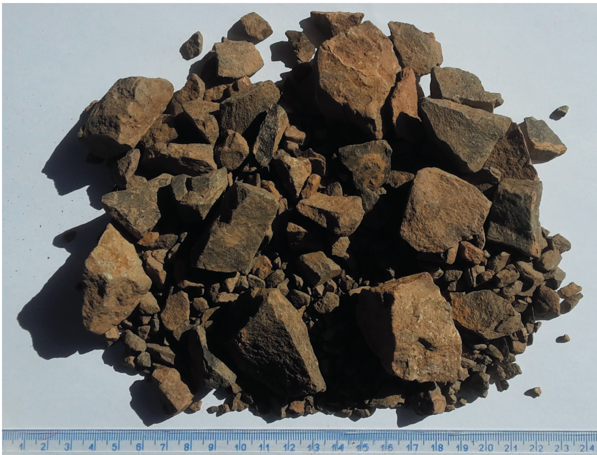
Rys. 6. Kruszywo bez frakcji pylastej zdominowane przez melafiry o teksturze afanitowej i diabazy (próbka nr 1)
