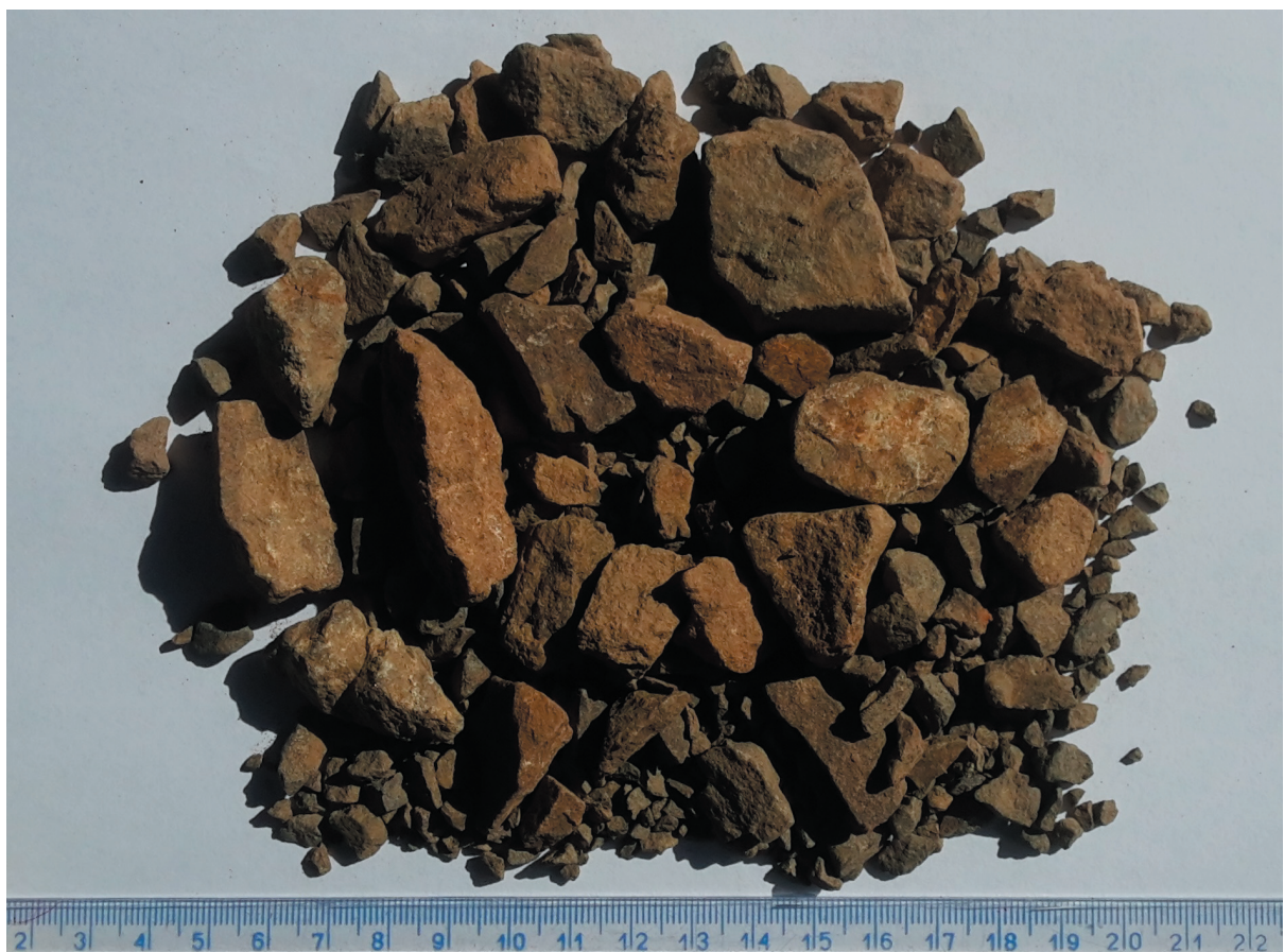
Rys. 7. Kruszywo bez frakcji pylastej zawierające głównie melafiry o strukturze porowato-migdałkowej oraz melafiry o teksturze afanitowej (próbka nr 4)
