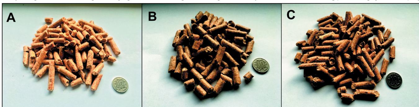
Rys. 1. Pellet dostępny na rynku polskim przeznaczony do spalania w kotłach c.o. na paliwa stałe. 1A- pellet z trocin drzew iglastych, 1B- pellet z trocin drzew iglastych i liściastych, 1C- pellet z trocin drzew liściastych
