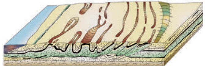
Rys. 3. Zróżnicowane kształty wychodni pokładu węgla w zależności od rodzaju struktury glacictektonicznej, na podstawie [12].
