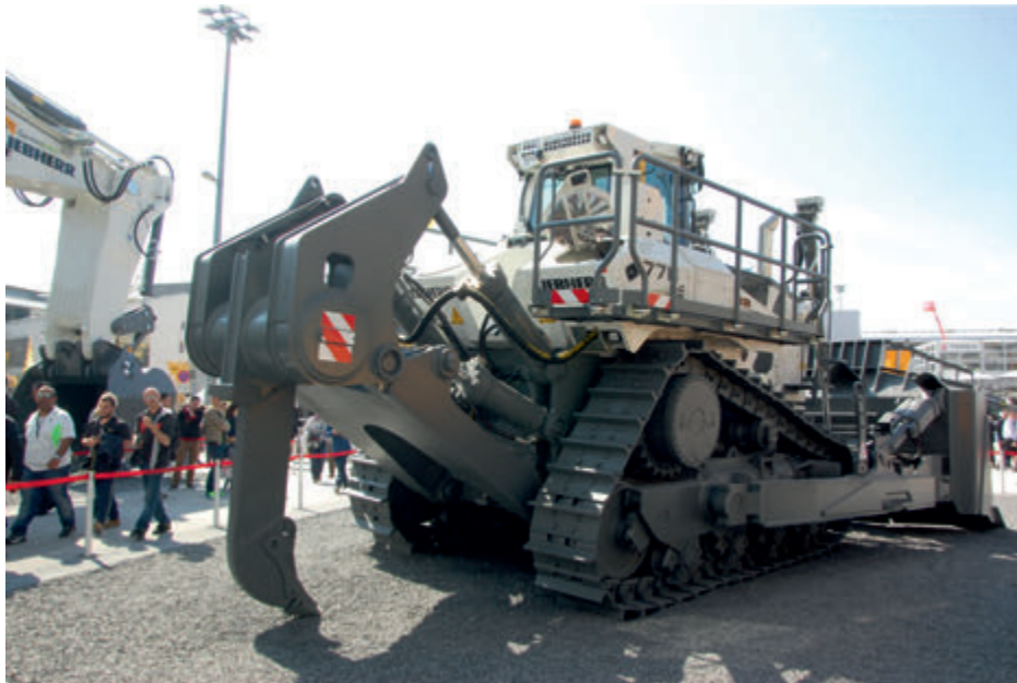
Rys. 1. Ciężka spycharka Liebherr 776 z napędem hydrostatycznym przeznaczona dla górnictwa odkrywkowego [materiały własne] Fig. 1. Hydrostatic travel drive dozer Liebherr 776
