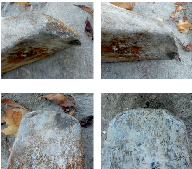
Rys. 6. Stępione (zużyte) zęby zrywaków [7]
