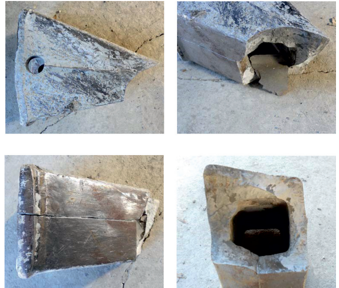
Rys. 7. Pęknięcia zmęczeniowe zębów zrywaków [7]
