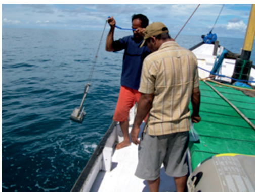
Fot. 2. Metoda poboru osadów z dna Morza Arafura (fot. Roman Group Pte. Ltd.)
