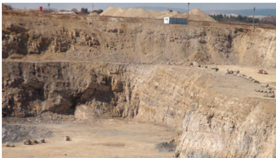
Ściana przygotowana do odstrzału
