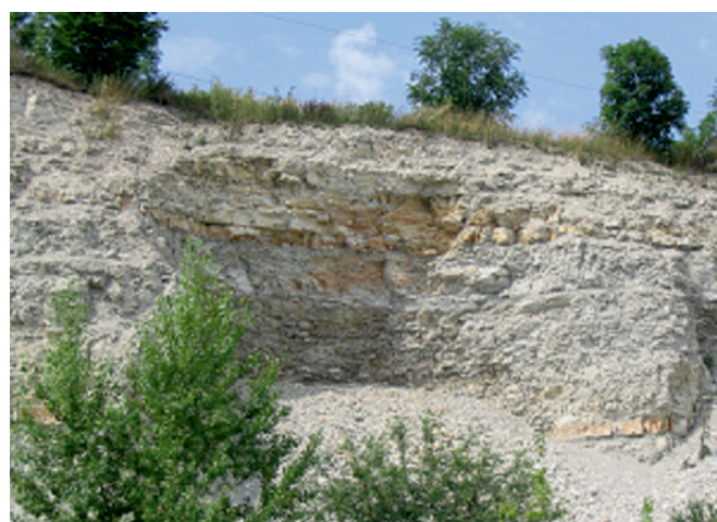
Rys. 8. Procesy wietrzeniowe na skarpie w nieczynnej, NE część kamieniołomu Fig. 8. Erosion in NE, not operated part of the mine
