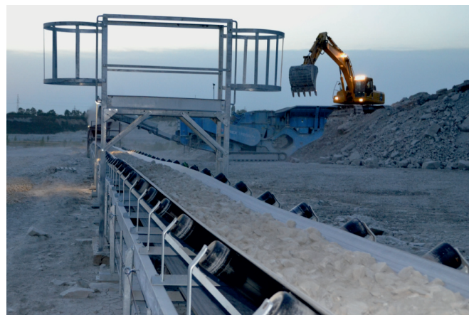
Rys. 7. Załadunek wapieni koparką Komatsu Fig. 7. Loading of limestones by Komatsu excavator
