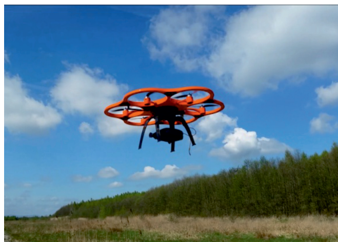
Fot. 3. Hexakopter używany do skaningu laserowego
