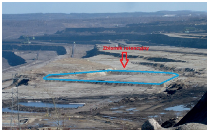
Fot. 10. Tymczasowy zbiornik retencyjny o pojemności 260 tys. m 3 wykonany przez koparkę K-28
