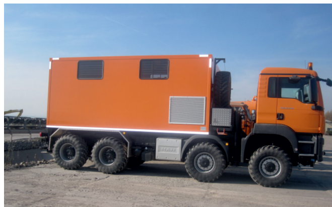
Fot. 1. Sonda statyczna GRIZZLY 200 kN
