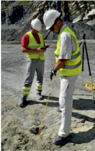
Rys. 4. Sonda „Boretrak” wykorzystywana przez firmę Maxam do laserowego profilowania otworów [2] Fig. 4. The probe „Boretrak” used by „Maxam” for laser profiling of holes [2]
