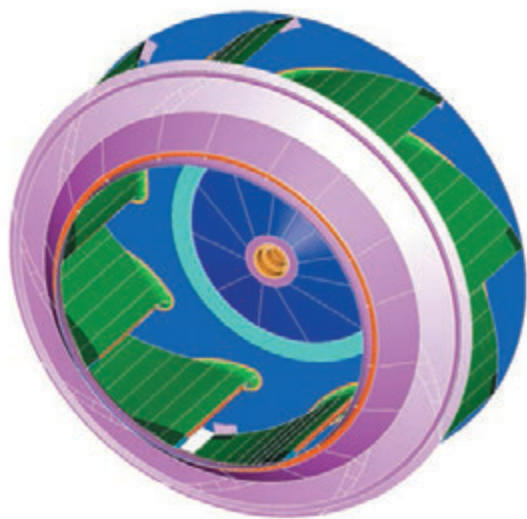
Rys. 1. Model dziewięciopatkowego wirnika WPK-5,3
