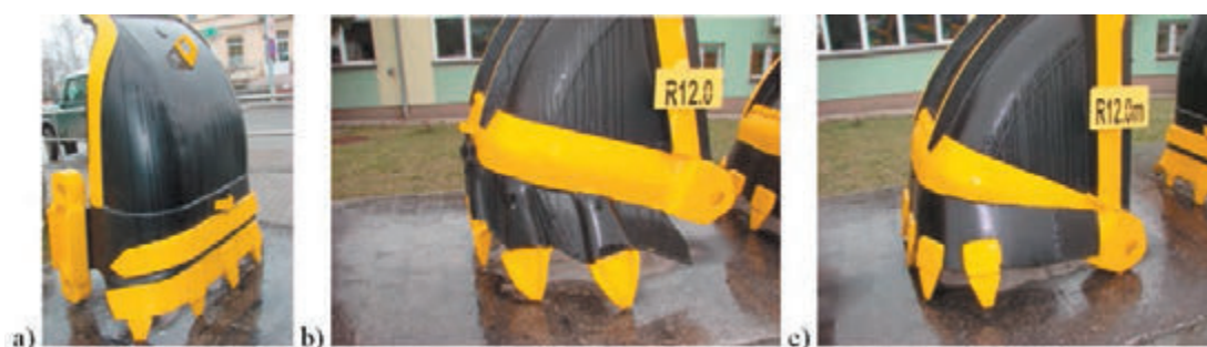
Rys. 3. Podstawowe typy czepaków stosowane w KWB Turów a) Rs 560, b) R12 0 z zębami wymiennymi WKL, c) R12.0M z zębami stałymi
