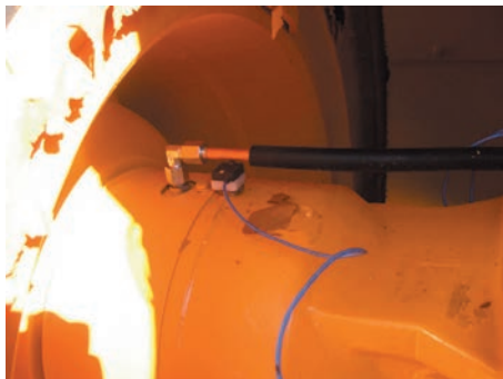
Rys. 4. Czujnik przyspieszeń a1 umieszczony na osi przedniej
