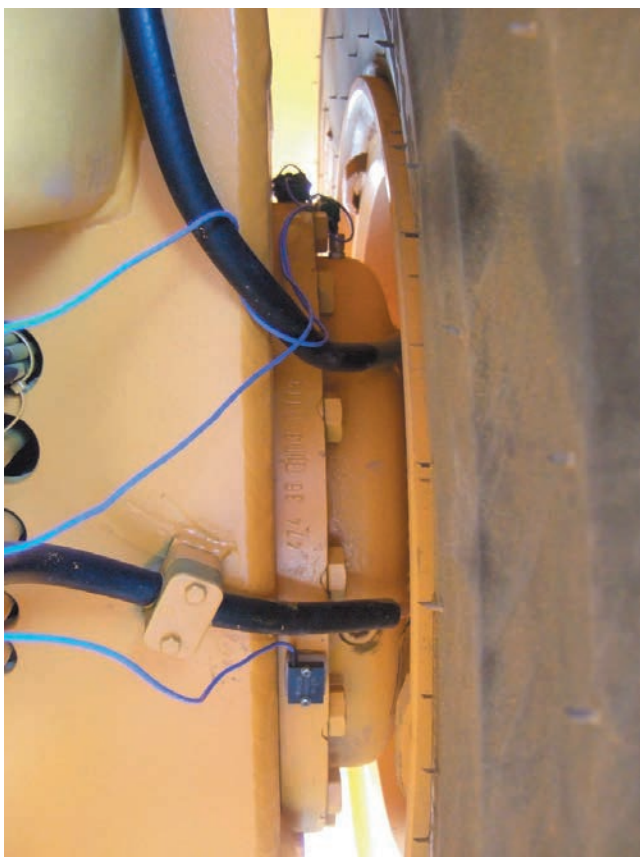
Rys. 5. Czujniki przyspieszeń a7, a8, a9 umieszczony na osi tylnej
