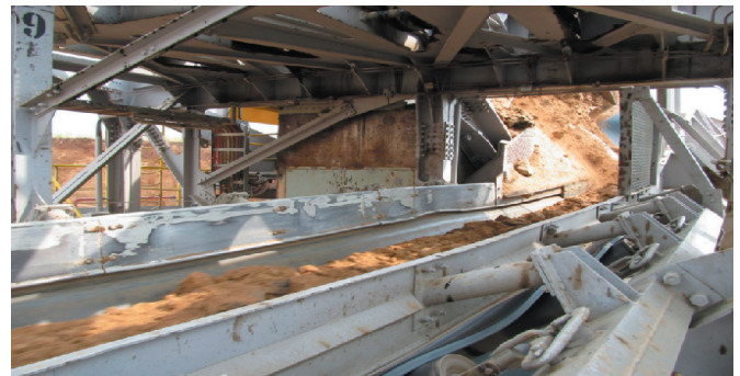
Rys. 1. Przenośnik taśmowy na wysięgniku koła czepakowego koparki kołowej (archiwum własne autorów)
