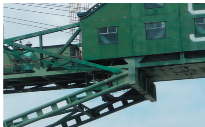
Rys. 5. Podparcie pod skrzynią przeciwwagi – koparka KWK1500
