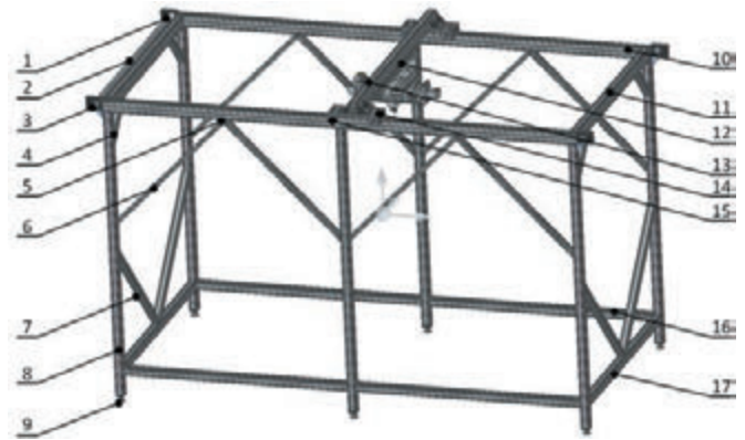
Rys. 4. Schemat ramy nośnej z wykazem elementów składowych [8]
