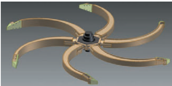
Rys. 6. Model 3D koła wygarniającego [1]
