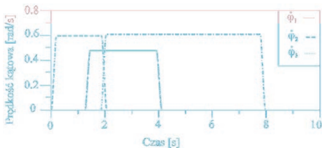
Rys. 6. Zmienność prędkości kątowych w funkcji czasu dla zestawu zmiennych decyzyjnych stanowiących szukane optimum
