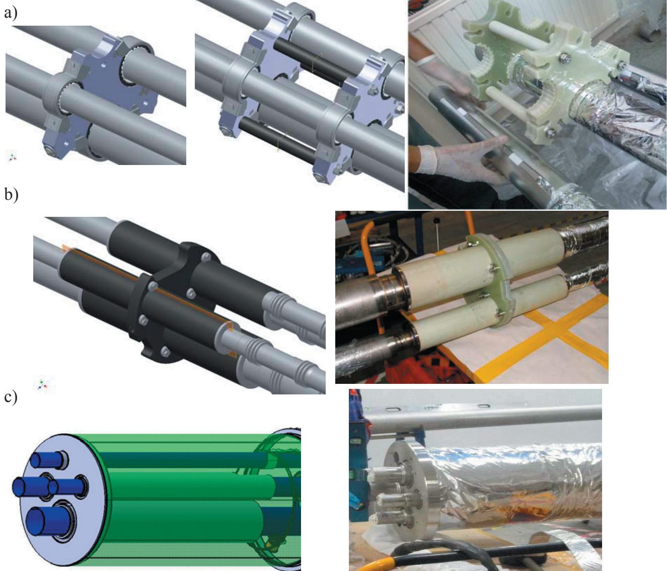
Rys. 7. Podpory rur procesowych – modele i obiekty rzeczywiste: a) pojedyncza i podwójna podpora przesuwna, b i c) podpory stałe
