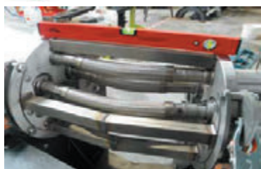
Rys. 9. Kompensatory i elastyczne węże – modele 3D i obiekty rzeczywiste
