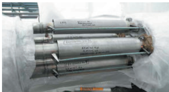
Rys. 8. Podpory ekranu termicznego – modele i obiekty rzeczywiste na montażu
