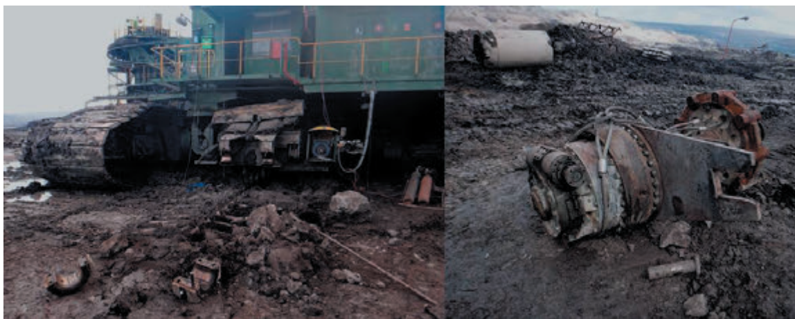
Rys. 1. Zestaw gąsienicowy ze zdemontowanym napędem jazdy po awarii przekładni
