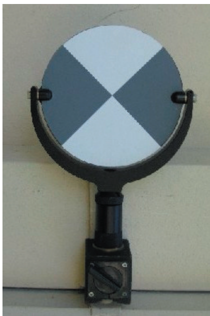
Rys. 2. Widok tarczy/znacznika wykorzystywanego do łączenia skanów
