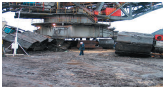
Rys. 3. Pęknięcie osi w gąsienicowym układzie jazdy zwalówarki A 2 RsB-12500
