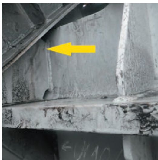
Rys. 13. Badania defektoskopowe nieniszczące: a) pęknięcie w konstrukcji wyrzutnika kamieni, b) produkty korozji, będące efektem braku odpływu wody
