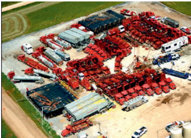
Rys.9. Otoczenie głowicy wydobywczej podczas zabiegu szczelinowania [15]
