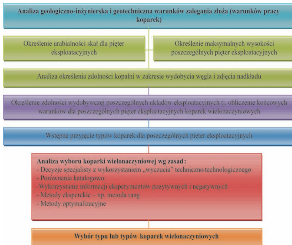
Rys. 6. Schemat blokowy doboru koparek wielonaczyniowych do kopalń odkrywkowych Fig. 6. Block diagram of the bucket ladder excavator selection for open pit mines
