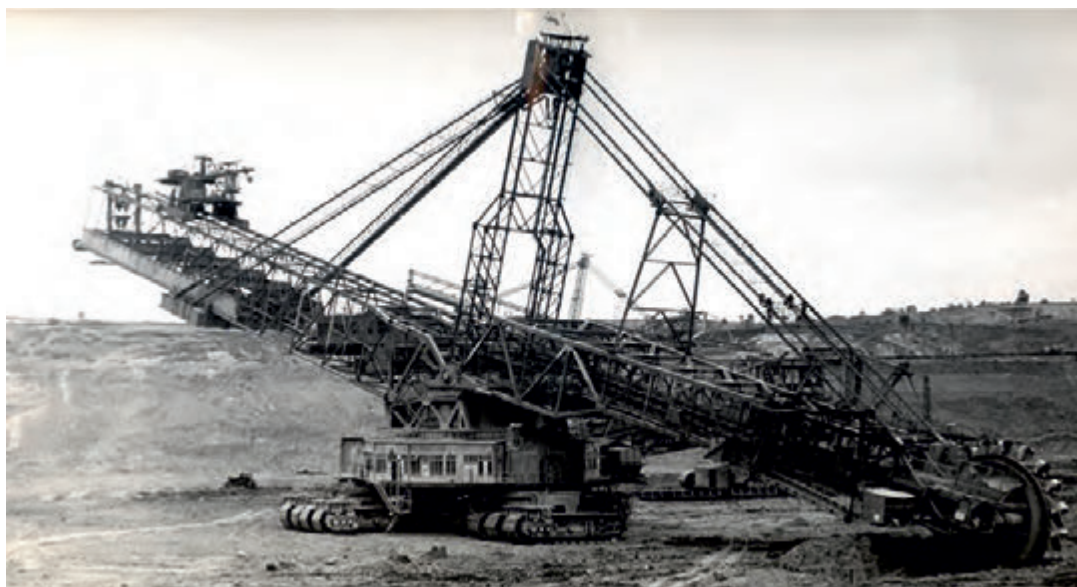
Rys. 1. Koparka SRs 2400 podczas badań, urabiająca podpoziomowo nadkład w Kopalni Machów
