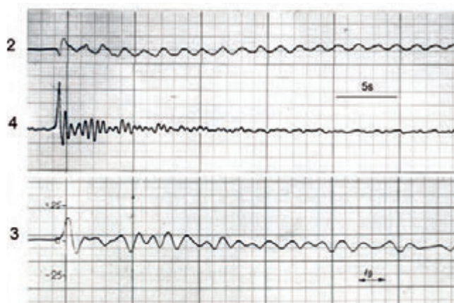
Rys. 6. Zanikające drgania swobodne wysięgnika koła czerpakowego koparki SRs 2400
