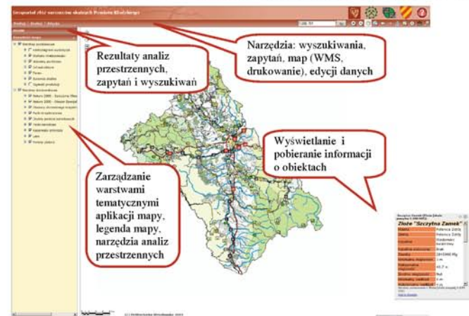
Rys. 1 Prototyp interfejsu graficznego aplikacji mapy Pilotowego systemu geoinformacyjnego złóż surowców (Blachowski et al., 2011)
