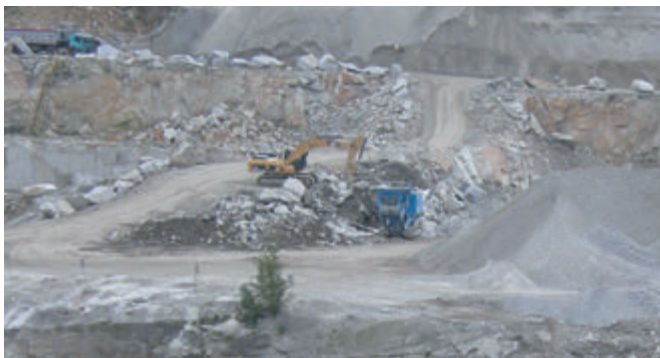
Fot. 1, 2. Układ z mobilnymi urządzeniami przeróbczymi oraz transportem samochodowym Photo 1, 2 System with mobile processing machines and motor transport
