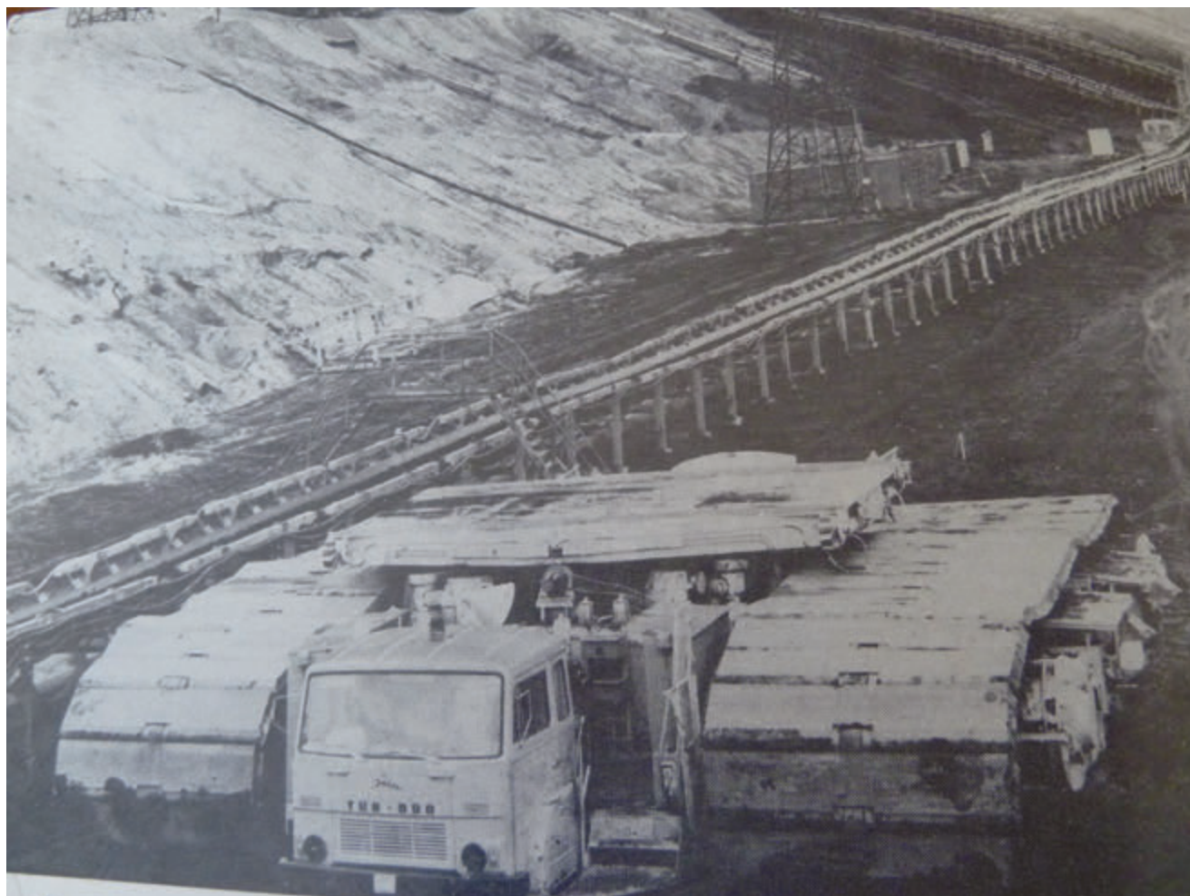
Transporter gąsienicowy TUR 500 do przestawiania stacji napędowych (1800 mm)
