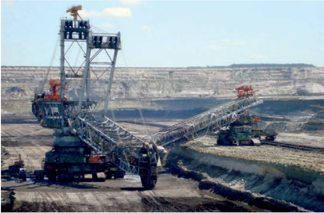
Fot. 9. Selektywna eksploatacja bruków krzemienych z IV poziom Pola Szczerców Fot. 9. Selective extraction of flinty pavement from the IV level of Szczerców Field
