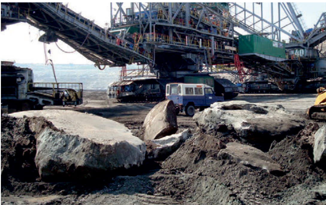
Fot. 10. Piaskowce kwarcytowe zalegające w zakresie robót górniczych VI poziomu Pola Belchatów Fot. 10. Quarcitic sandstone on the VI level of Belchatów Field
