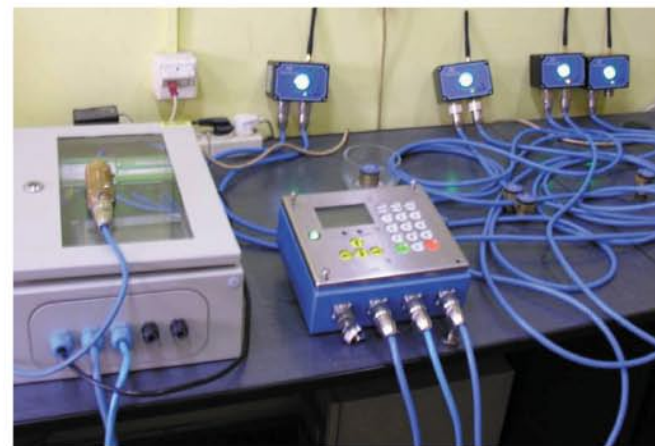
Rys. 6. Elementy podsystemu bezprzewodowych czujników temperatury w czasie badań laboratoryjnych Fig. 6. Elements of wireless heat detectors subsystem during laboratory tests
