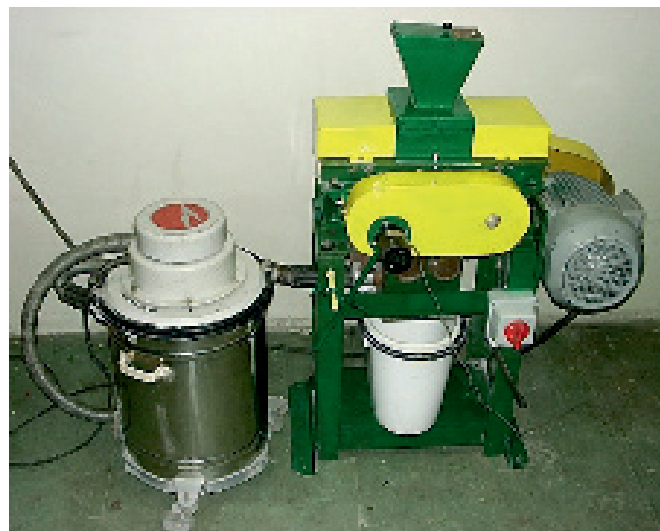
Rys. 1. Stanowisko badawcze wibracyjnej kruszarki szczękowej KW 40/1 [7] Fig. 1. Research station of the vibratory jaw crusher [7]
