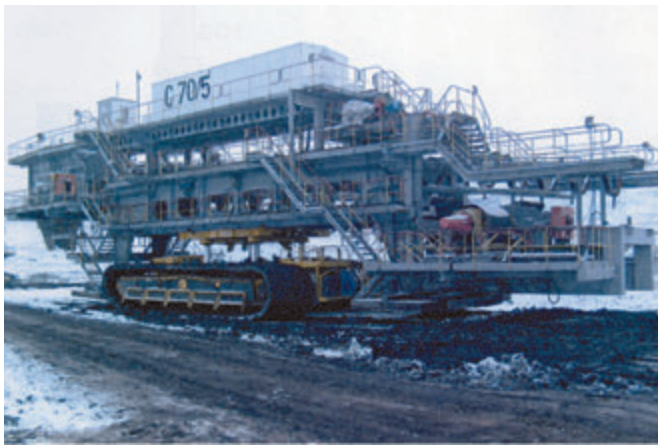
Rys. 3. Transporter TUR 600 podczas badań obciążony stacją napędową C70/5 [2]
