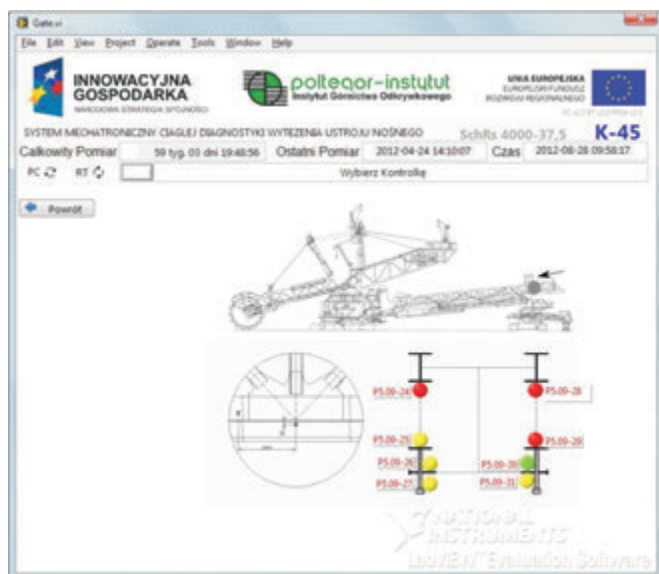
Rys. 8. Schemat rozmieszczenia punktu pomiarowego na moście podającym
