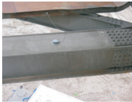
Rys. 3, 4, 5. Przykłady rozmieszczenia punktów pomiarowych na ustroju nośnym koparki Fig. 3, 4, 5. Examples of measuring points configuration on excavator load carrying structure
