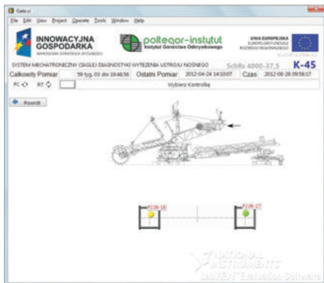
Rys. 7. Schemat rozmieszczenia punktu pomiarowego na przeciwwadze
