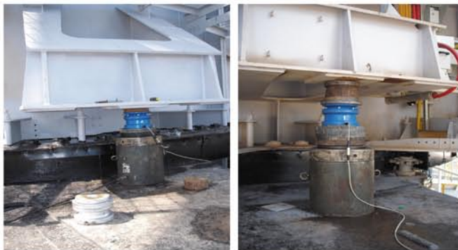
Rys. 5. Tensometryczne czujniki sił do pomiaru reakcji podporowych Fig. 5. Strain gauges for supports reaction measurements
