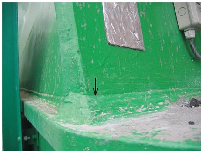
Rys. 11. Miejsce potencjalnego pęknięcia wytypowane do analizy lokalnej
