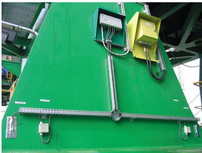
Rys. 5. Czujniki zainstalowane w narożach słupa wieży Fig. 5. Sensors installed in the corners of tower pillar
