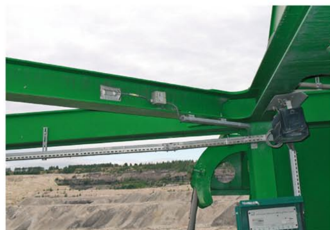
Rys. 3. Czujnik zainstalowany na środku zastrzały stężeń górnych wysięgnika koła czerpakowego
