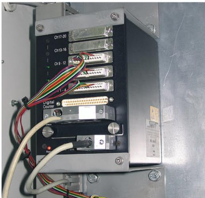
Rys. 7. Urządzenie MAS-MICRO-II RECORDER firmy Swift służące do gromadzenia i wstępnej obróbki sygnałów ze wzmacniaczy
