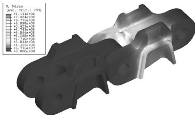
Rys. 4. Rozkład naprężeń zredukowanych w parze ogniów po zastosowaniu modyfikacji I i II (opis w tekście)
