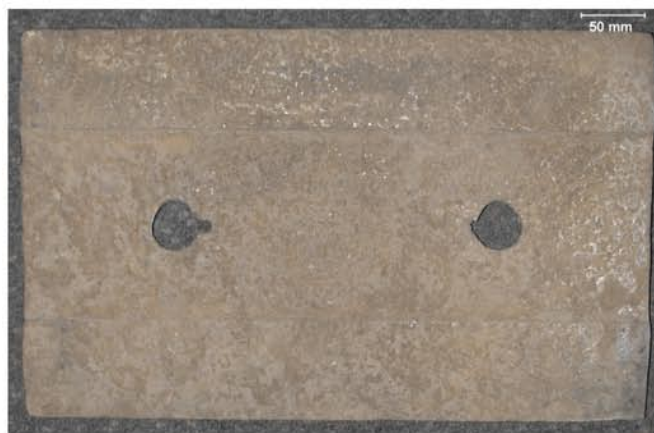
Rys.2. Próbka 2. Makroskopowy obraz stanu powierzchni płyty wykładzinowej młyna kulowego osłaniającej część konstrukcji zsypu.
