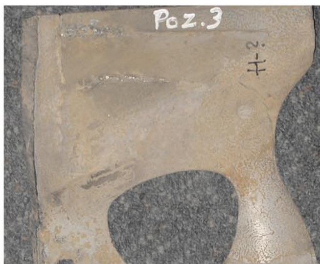
Rys.3. Próbka 3. Makroskopowy obraz stanu powierzchni blachy wykładzinowej przesypu. Grubość początkowa 30 mm, uziarnienie materiału 35 – 60 mm, szybkość spadku melaufiru 2 m/s, czas pracy około 450 godzin, przerób około 200 000 ton
