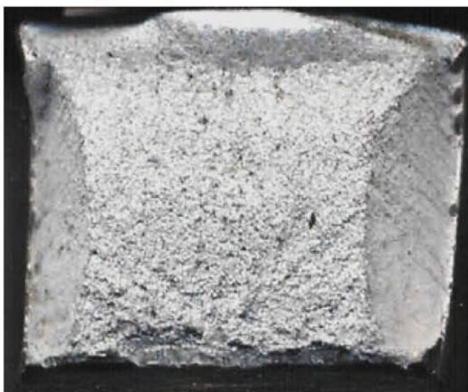
Rys. 19. Obraz makroskopowy przelomu stali gatunku B27 – stan po hart/odp. Temp. badania 20°C
