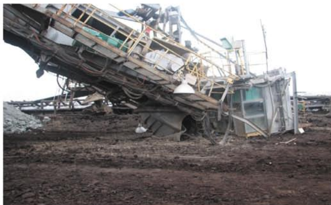
Rys. 2. Efekt awarii mechanizmu zwodzenia końcówki wysięgnika odbierającego
