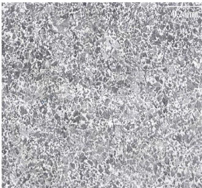
Rys. 9. Mikrostruktura materiału śruby. Jasne obszary ferrytu okalające ciemne ziarna perlitu. Powiększenie 100x. Trawiono MilFe , mikroskopia świetlna
