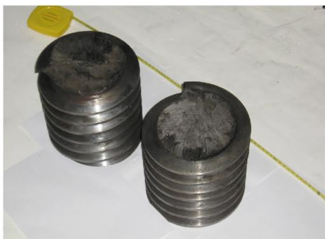
Rys. 7. Oba fragmenty rozerwanej śruby w miejscu przełomu
