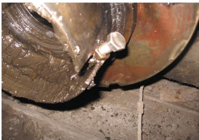
Rys. 4. Pojedyncza śruba przekazująca moment obrotowy z nakrętki brązowej na nakrętkę stalową. Widać jak wysunęła się z prowadnicy i poluźniła nakrętkę stalową, która przestała się z związku z tym przesuwac po śrubie
