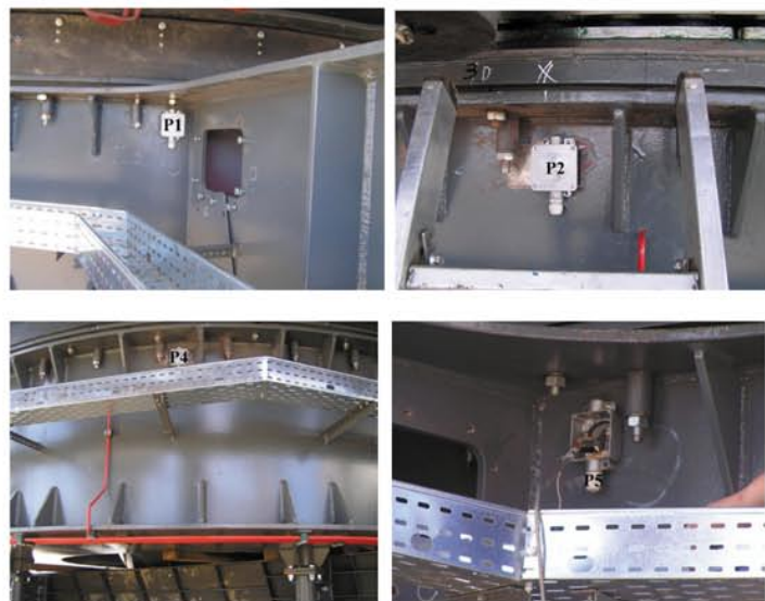
Rys. 3. Rozmieszczenie punktów pomiarowych na obwodzie dźwigara pierścieniowego ładowarko-zwałowarki LZKS 500.29,5 Fig. 3. Localization of measurement points on the circumference of LZKS 500.29,5 stacker-reclaimer ring girder
