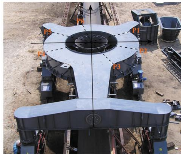
Rys. 2. Współrzędne położenia środka ciężkości nadwozia m^2 LZKS 500.29,5 w funkcji kąta obrotu \varphi i kąta pochylenia \delta Fig. 2. Coordinates of the body gravity center m^2 LZKS 500.29,5 in the function of rotation angle \varphi and inclination angle \delta
