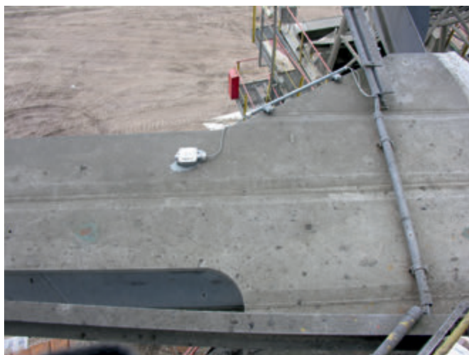
Rys. 6. Przykład rozmieszczenia tensometrycznych punktów pomiarowych
