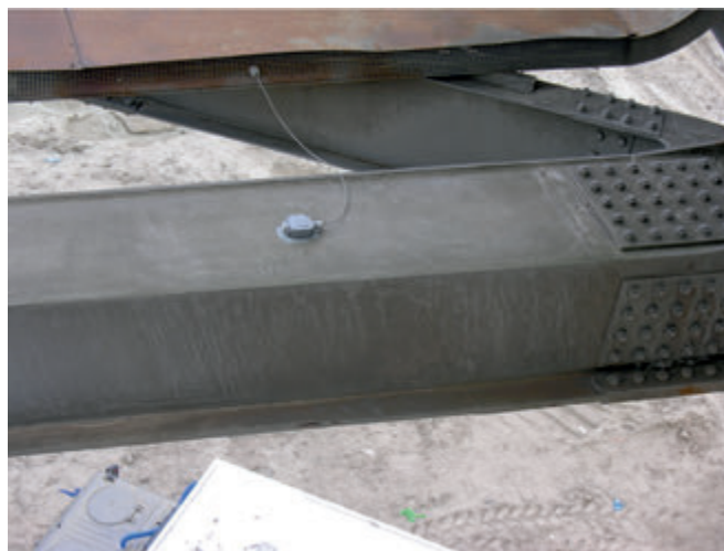
Rys. 7. Przykład rozmieszczenia tensometrycznych punktów pomiarowych
