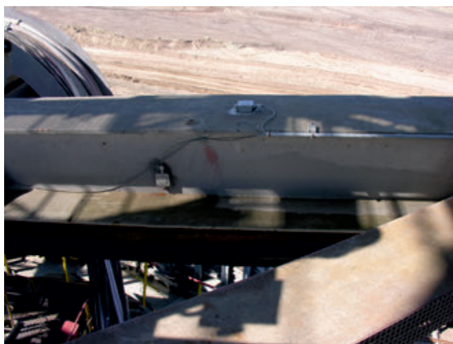
Rys. 5. Przykład rozmieszczenia tensometrycznych punktów pomiarowych
