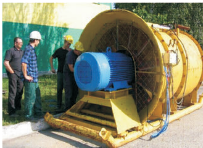
Rys. 6. Silnik synchroniczny z magnesami trwałymi o mocy P=160 kW z wentylatorem typu WOO 200B
