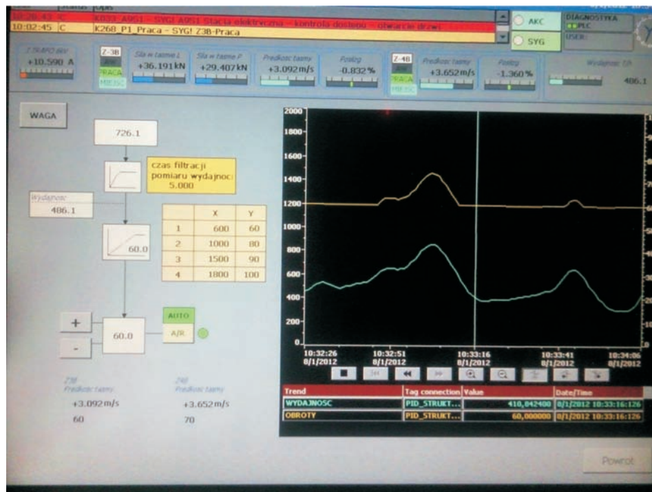
Rys. 3. Widok ekranu systemu sterowania przenośnikami taśmowymi dla układu przenośnika Z-3B Fig. 3. View of the screen of the system of control belt conveyor for the configuration of conveyor Z-3B
