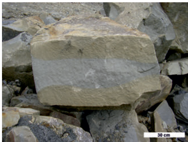
Rys. 3. Strefa zwietrzenia (faza B) rozwijająca się od brzegów do wnętrza bloku piaskowca
