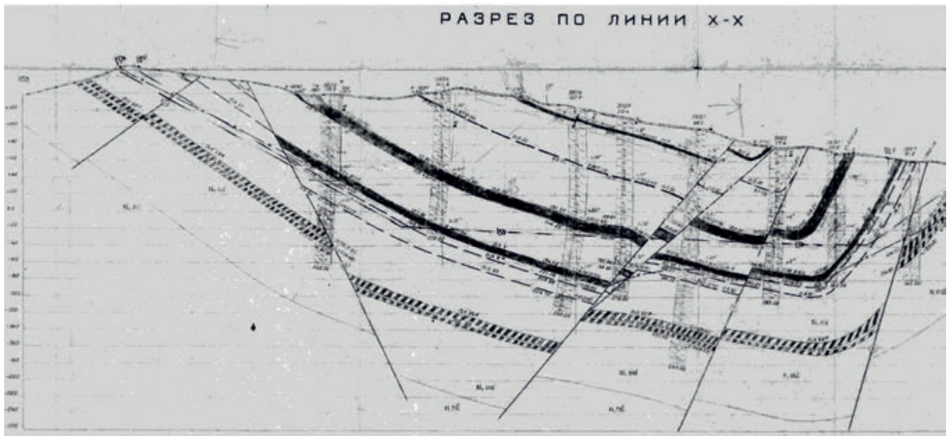
Rys. 4. Przekrój zawierający interpretację geologiczną struktury pokładów Fig. 4. Cross-section containing geological interpretation of seams structure
