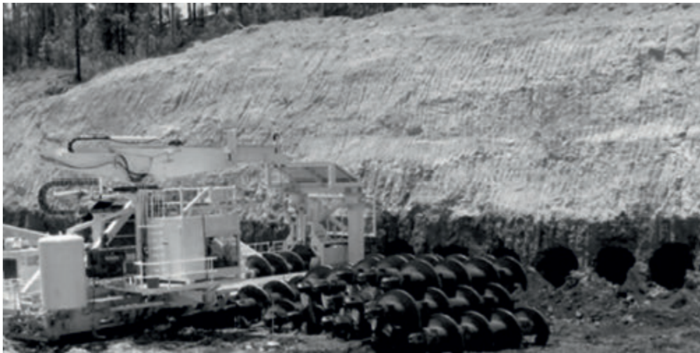
Rys.3. Widok urobionej części pokładu węgla i stosowany sprzęt ( Auger mining )
