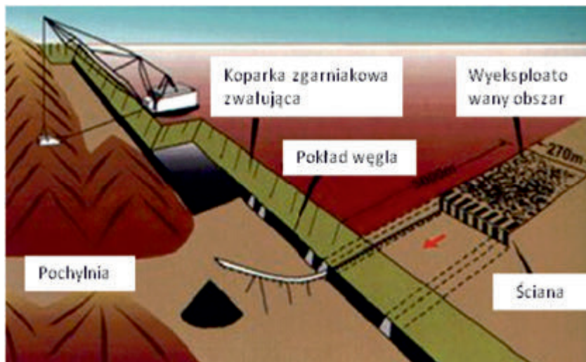
Rys.3. Widok urobionej części pokładu węgla i stosowany sprzęt ( Auger mining )
