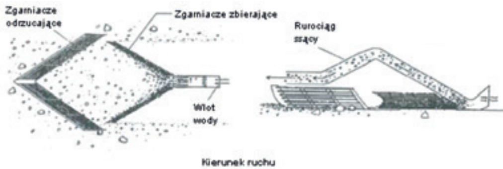
Rys. 6. Zasada działania zgarniaka pasywnego [8]
