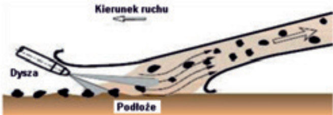
Rys. 11. Działanie organu zbierającego agregatu hydraulicznego oparte na zasadzie podnośnika hydraulicznego [8] Fig. 11. Principle of operation of hydraulic collecting unit based on a hydraulic lift technical solution [8]
