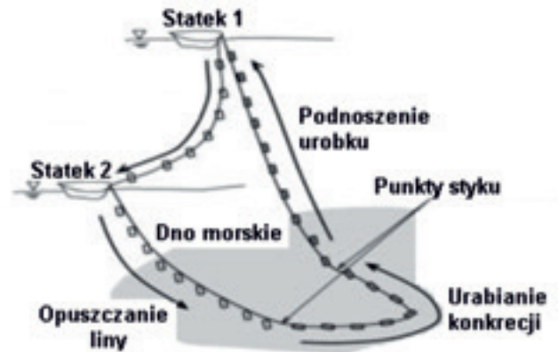
Rys. 3. Zasada mechanicznego (linowego) systemu wydobywania kongrecji [2] Fig. 3. The principle of mechanical (cable) system exploitation of polymetallic nodules [2]
